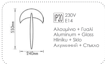
Απλικά διαδρόμων Corridor wall luminaire E14
